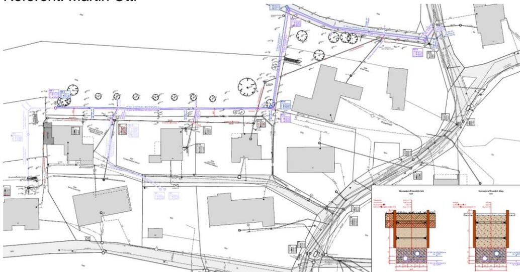
Die betroffene Abwasserleitung der angeschlossenen Liegenschaften ist stark sanierungsbedürftig und muss neu erstellt werden. Die Entwässerung erfolgt im Trennsystem.
