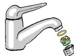
Abbildung 2: Durchfluss- und Druckminderer für Wasserhähne)
